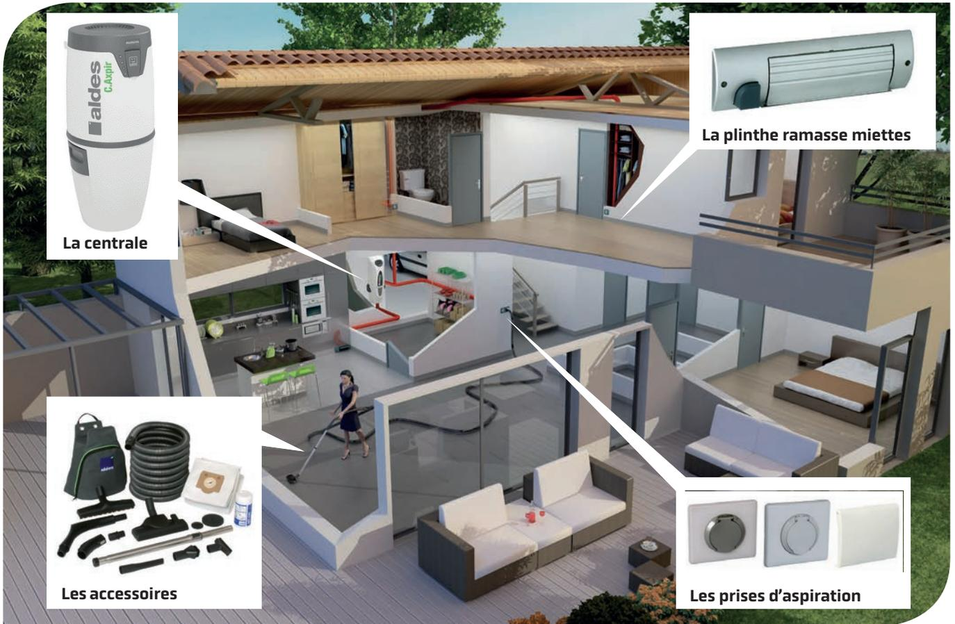
L'aspiration centralisée est un système d'aspiration basé sur l'installation de conduits à l'intérieur même de l'habitation. Elle est composée d'un aspirateur (souvent installé dans le garage), de tuyaux en PVC présents dans les murs de l'habitation. Ces derniers sont reliés à l'aspirateur et entre eux pour former un réseau qui se raccorde sur les prises d'aspiration.
